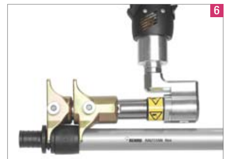
A toldóhüvely felpréselése az idomra
